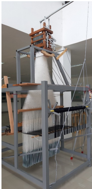
รูปที่ 3.1 การติดตั้งหัวแจ็กการ์ด
