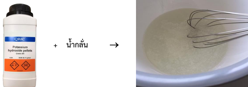
ภาพที่ 4.10 การเตรียมสารละลายโพแทสเซียมไฮดรอกไซด์ (น้ำด่าง)
