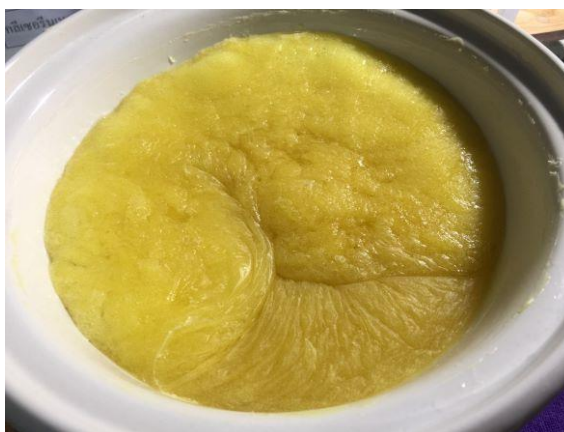
ภาพที่ 4.13 สบู่เข้าสู่ heavy trace
