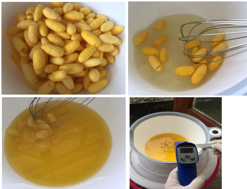
ภาพที่ 4.2 การเตรียมสารละลายไหมในน้ำค้าง
